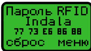
Для включения функции финализации (форматы Dallas, EM-Marine, HID, Indala) или пароля (формат EM-Marine, HID, Indala), при записи ключей нажмите кнопки «Вверх» или «Вниз». После считывания ключа функции финализации и пароля отключены.
